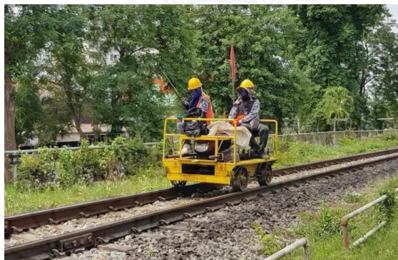
ภาพที่ 1 การตรวจสอบเส้นทางรถไฟด้วยรถตรวจราง
