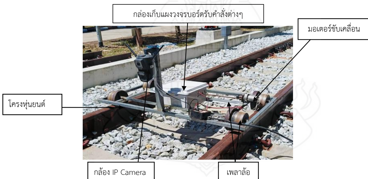
ภาพที่ 2 หุ่นยนต์ตรวจจับความเสียหายของเส้นทางรถไฟด้วยกล้อง IP camera
